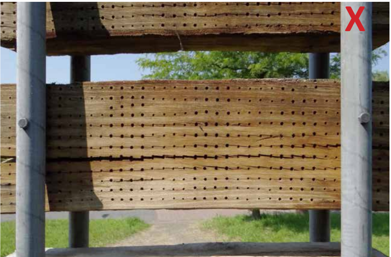
6.10 Door de overlangse scheuren in dit acaciahout is deze nesthulp vrijwel nutteloos.
