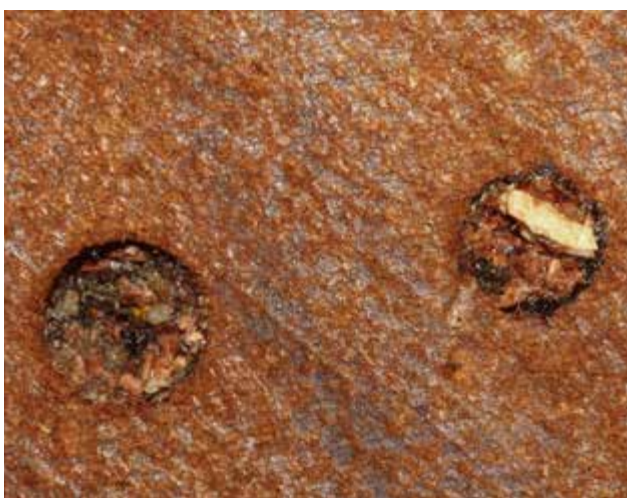
13.64 Afsluitproppen van tronkenbijen (4 en 5 mm doorsnede) vrijwel gelijk met het oppervlak van het hout.
